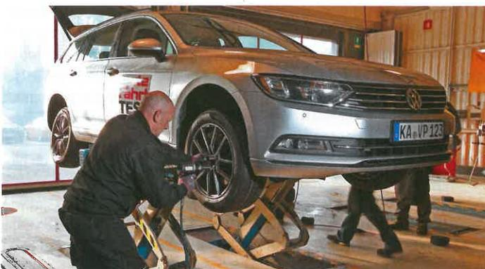
➔ Zur Ermittlung des exakten Bremswegs sind mindestens 10 Bremsungen pro Reifenmarke erforderlich
