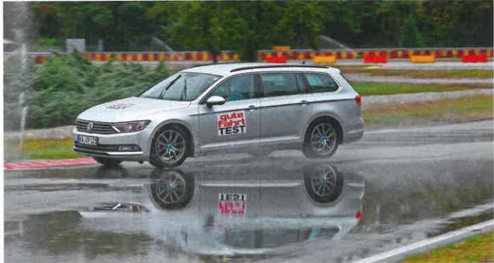
eine möglichst hohe Querbeschleunigung bei neutralem Lenkverhalten zu erzielen. Mit minimalstem Abstand setzt sich hier der Vredestein vor dem Dunlop an die Spitze, doch auch Goodyear und Maxxis bauen hohe und damit sehr gute Seitenkräfte auf. Lediglich Firestone und Toyo fallen mit spür-
