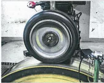
... Etwa 15 Prozent beträgt der Unterschied im Rollwiderstand zwischen dem Spritsparer von Goodyear und dem Vredestein Wintrax xtreme S, der einen überraschend hohen Messwert liefert. Theoretisch könnte das eine Kraftstoffersparnis von etwa drei Prozent bedeuten, im normalen Straßenverkehr ist dieser Verbrauchsvorteil aber kaum wiederzufinden.
