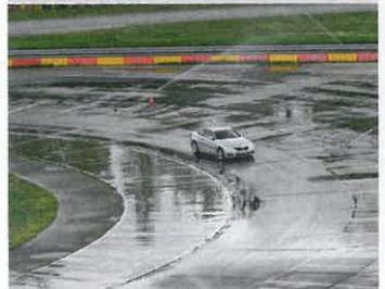
... Ohne eine überzeugende Seitenführung an der Vorderachse kommt es zu verzögertem Einlenken oder zu schnödem Untersteuern in der Kurve. Goodyear und Continental überzeugen mit Grip auf nasser Oberfläche. Der Accelera versagt dagegen komplett auf der Kreisbahn. Seine Mischung findet bei Nässe keine Haftung, er schiebt gnadenlos aus der Spur.
