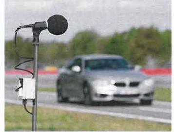
... Laute Abrollgeräusche von Winterreifen sind schon lange Vergangenheit. Heute liegen die Messwerte teilweise sogar unter denen eines Sommerreifens. Das Vorbeifahrgeräusch wird bei abgeschaltetem Motor auf einer speziell für diesen Test genormten Strecke aufgenommen. Im Fahrzeuginneren lassen sich die Unterschiede in der Lautstärke nicht ausmachen.
