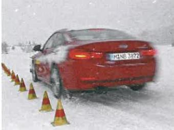
... Beim Bremsen liefert der Michelin Pilot Alpin 4 die kürzesten Bremswege, die Traktionsmeister von Goodyear und Dunlop liegen knapp dahinter. Selbst mit den beiden schwächsten Kandidaten bleibt man bei Schnee und Eis immer auf der sicheren Seite. Der Sommerreifen ist dagegen so tauglich wie eine Badehose: Der BMW kommt erst nach 77 Metern zum Stehen.
