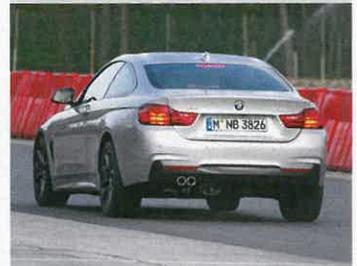
... Das Bremsen auf trockener Piste zählt leider nicht zu den Stärken eines Winterreifens. Jedenfalls im Vergleich zu einem Sommerreifen, der aus Tempo 100 knapp eine Wagenlänge vor dem Winterreifen zum Stehen kommt. Die Unterschiede zwischen dem besten und schlechtesten Bremsen liegen mit etwas über einem Meter aber sehr eng beisammen.
