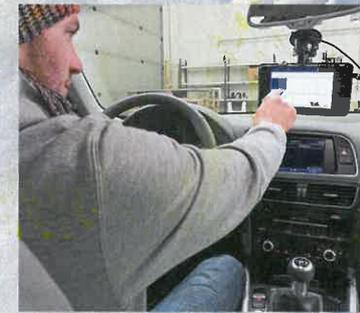
Die GPS-gestützte Elektronik protokolliert penibel jede Fahrt mit dem Testfahrzeug
