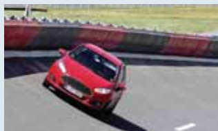
Spritverbrauch. Der Rollwiderstand der Reifen wird bei mehreren 100-km/h-Konstantfahrten gemessen
