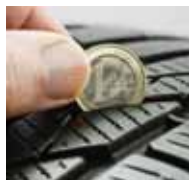
Das Profil der Sommerreifen verhindert Aquaplaning. 1,6 mm Restprofil fordert das Gesetz, der ADAC empfiehlt 3 mm. Tipp: Der Goldrand einer 1-Euro-Münze misst ca. 4 mm.
