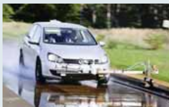
Nassbremsen. Das Testfahrzeug läuft auf einer Schiene
